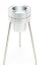
Штатив-тренога со встроенным уровнем и размещённым в нём вискозиметром
